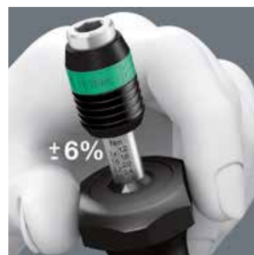
Přesnost měření \pm 6\% (výrobek 1430: \pm 10\% ) podle normy DIN EN ISO 6789. Výrazně slyšitelné a citelné přeskakování při dosažení nastaveného utahovacího momentu.
