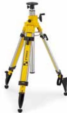
BST-K-L Výškově nastavitelný stavební stojan s tlumičím systémem, zajišťovací rozpěrkou a rychlouzávěrem. Výška: asi 98 – 220 cm Závit: 5/8" Váha: asi 6,5 kg
