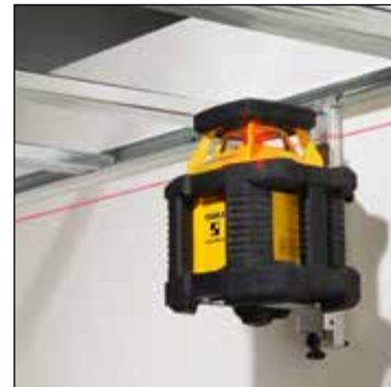
NK 100 Nivelační konzola Ideální při vnitřní výstavbě: výškově přestavitelná nivelační konzola (nástěnný držák) pro rotační laser. Zavěšuje se na profilovou kolejnici nebo na hřebík. Spektrum použití: Zavěšení stropů, pokládka podlah atd.
