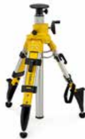
BST-K-M Výškově nastavitelný stavební stojan s tlumičím systémem, zajišťovací rozpěrkou a rychlouzávěrem. Výška: asi 69 – 170 cm Závit: 5/8" Váha: asi 6,0 kg
