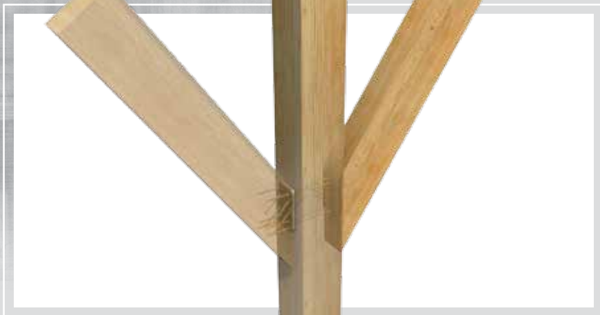
ŠIKMÉ SPOJENÍ S PODPĚRNÝM SLOUP- KEM (ZAVĚTROVÁNÍ)
