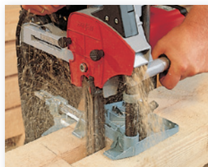
LS 103 Ec s vodícím nástavcem FG 150 pro dlaby do 140 mm.
