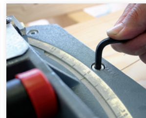
Drážkovací zařízení lze oboustranně do 45° naklopit.
