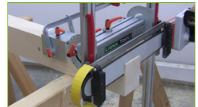
exakt schneiden - entlang der Führung
