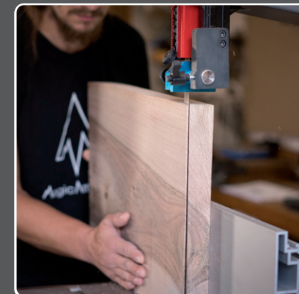
Výška řezu až 346 / 410 mm
