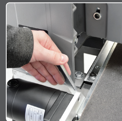
Páka pro přizvednutí stolu při broušení širokých dílců
