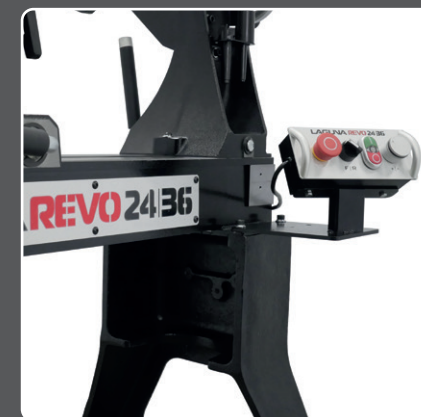
Druhý kompletní ovládací panel s možností dvojího uchycení
