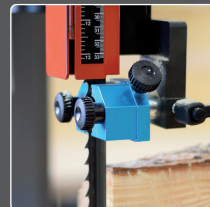
Keramická vodička pilového pásu
