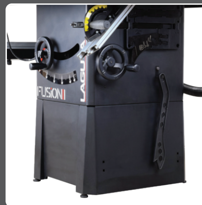
Ovládání naklonění a výšky řezu
