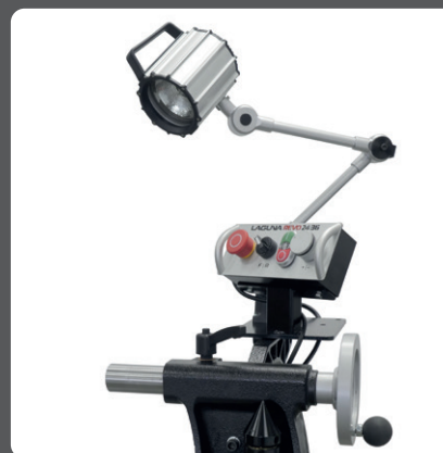
Druhý kompletní ovládací panel s možností dvojího uchycení
