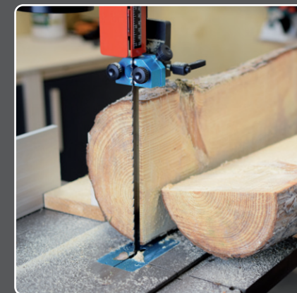
Výška řezu až 305 mm
