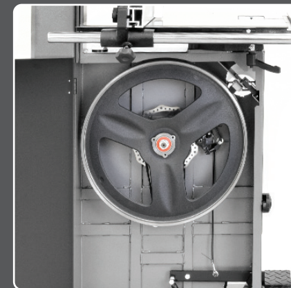
Kotoučová brzda pro rychlé zastavení
