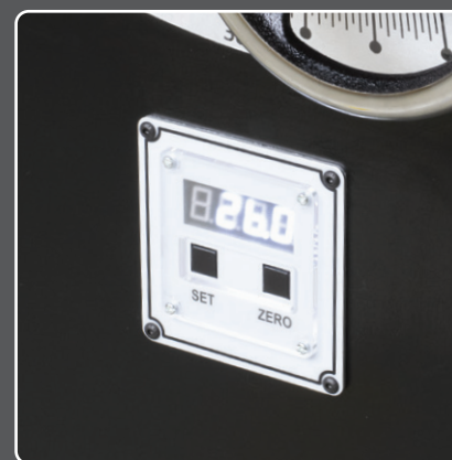
Digitální ukazatel úhlu pilového kotouče
