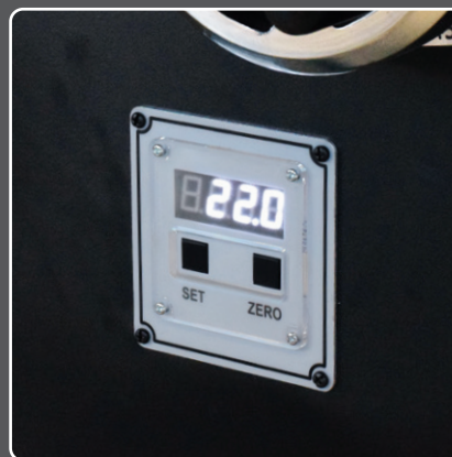
Digitální ukazatel úhlu pilového kotouče
