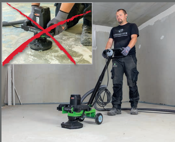
Rücken schonendes Arbeiten mit Bodenführungsgestell
