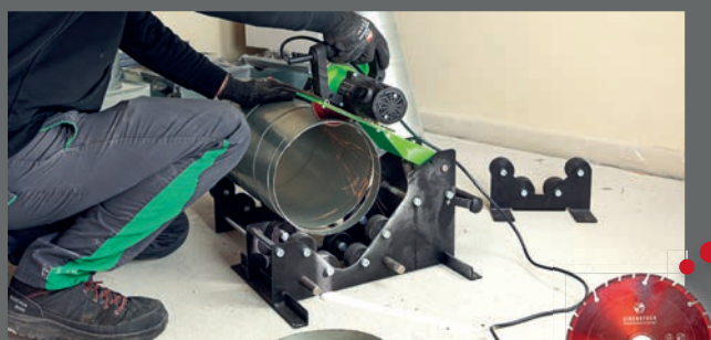
Zeitsparendes Trennen von Lüftungsrohren
