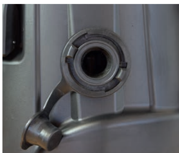
C- Rohr Anschluss für Abwasser
